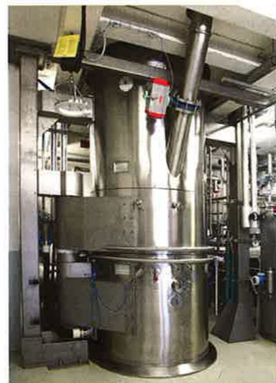
Seit zwei Jahren arbeitet Raps mit einer Anlage für das Luftgleitschichtverfahren. Raps has been working with a air flow bed coating system for two years now.
